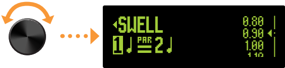
Adjusting a menu type parameter (Swell parameter)
